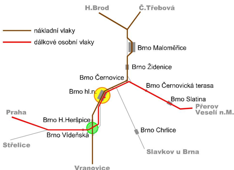
Obr.22 Vedení nákladního průtahu středem žst. Brno hl.n.
