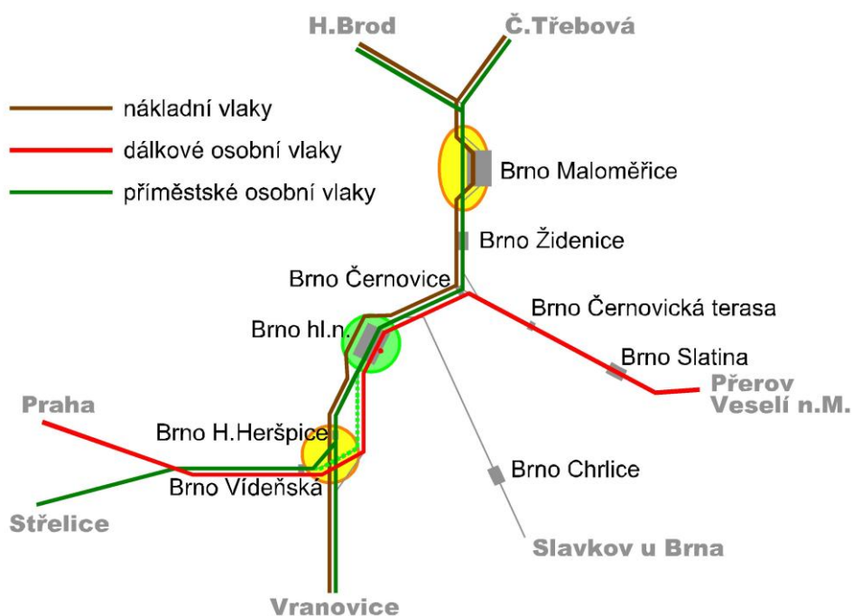
Obr.20 Vedení nákladního průtahu na západní straně žst. Brno hl.n.
